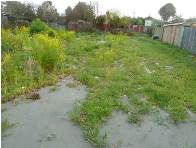
o) Liquefaction ejecta on lawn
