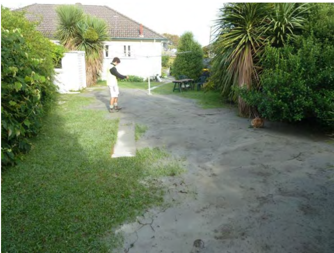
k) Liquefaction ejecta on lawn
