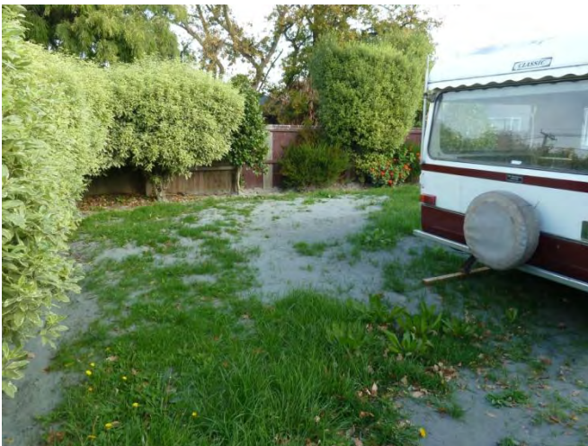
k) Liquefaction ejecta on lawn
